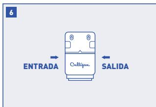
Delímite dos medidas diferentes de la manguera de 1 cm (3/8 in) necesarias para conectar la entrada y la salida del sistema al adaptador para suministro de agua (consulte la imagen para referencia de arriba para determinar la ubicación de la entrada y la salida). Asegúrese de que las medidas sean adecuadas para impedir que la línea se tuerza.
