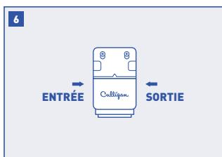
Déterminez deux longueurs différentes pour le tuyau de 0,125 po nécessaires pour connecter l'entrée et la sortie de la tête du système à l'adaptateur d'alimentation d'eau (voir l'illustration ci-dessus pour les emplacements d'entrée et de sortie). Assurez-vous de laisser suffisamment de tuyau pour éviter tout entortillement de la conduite.
