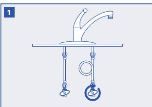
Desconecte la válvula de cierre de agua fría, abra el grifo de la cocina y deje que drene todo el agua de la línea.
